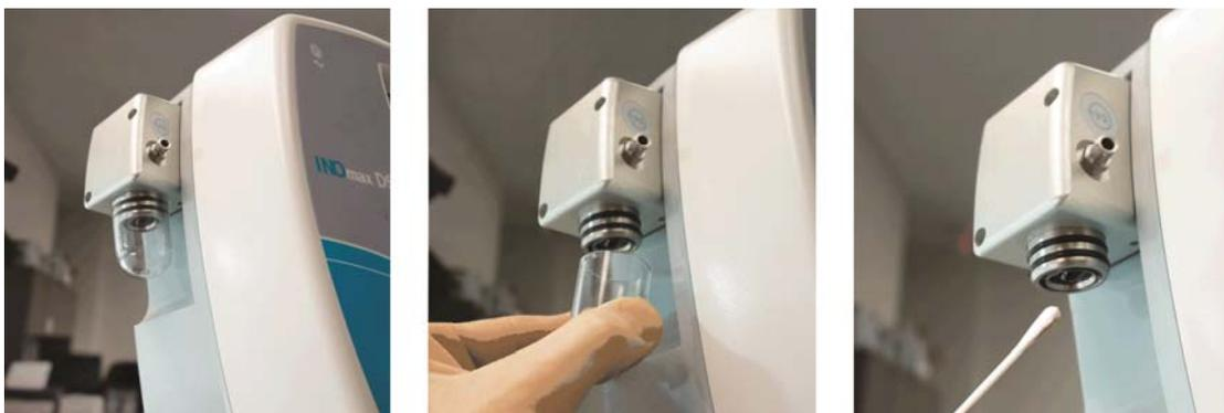
Figure 5. Retrait du Flacon de piège à eau pour nettoyage du flacon et du capteur optique
